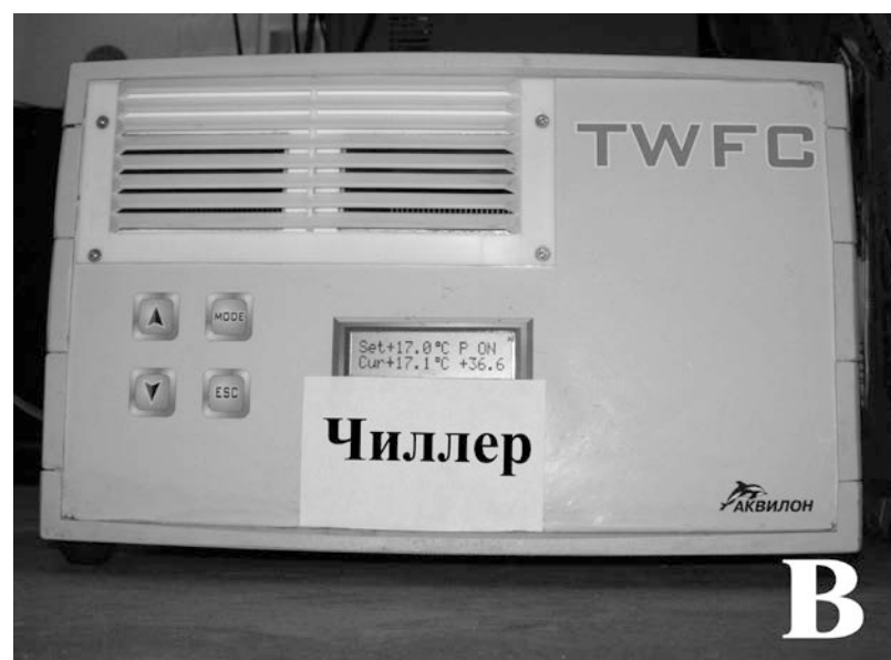
Рис. 5. Блоки накачки и охлаждения фемтосекундного лазера: (а) – оптоволоконный иттербиевый лазер накачки IPG PYL-10LP (снизу) и температурный контроллер (сверху), (б) – блок управления лазером накачки, (в) – чиллер.
