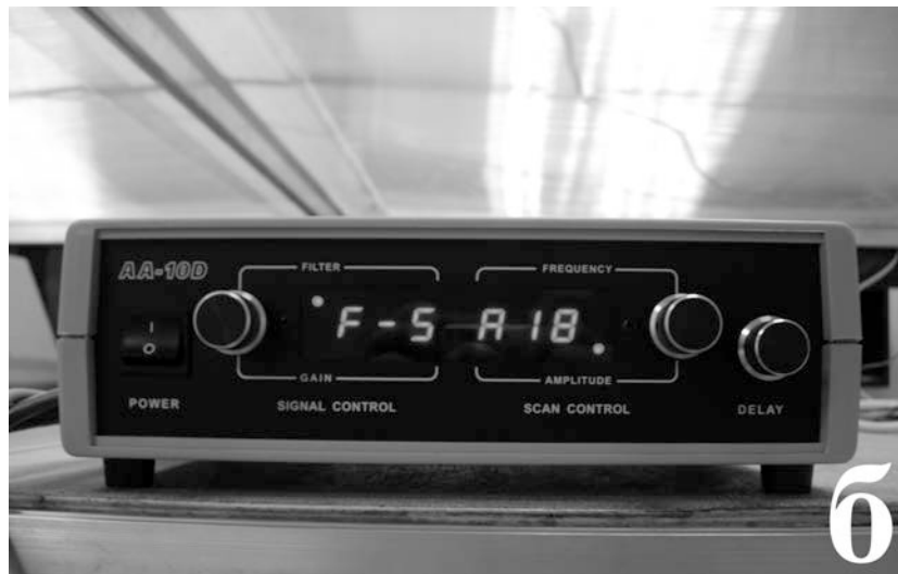
Рис. 6. (а) – автокоррелятор, (б) – блок управления автокоррелятором.
